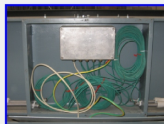
Kabelklemmkasten mit Messkabel
