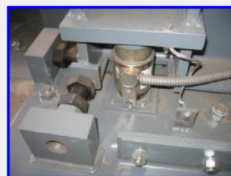
Wägezelle mit Pendellager und Stoßfänger
